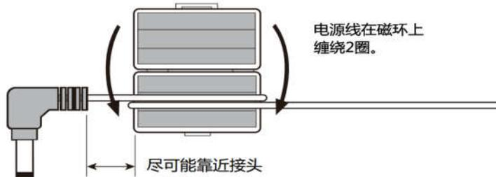
Note: 电源线在磁环上绕两圈（Wrap around two turns.）；尽可能靠近接头（As close as possible.）
